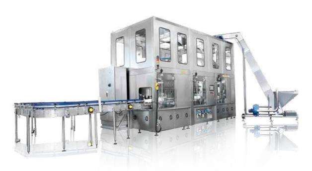
自达意隆首台外部液位检测定量灌装机推出,广受 青睐。此类型号灌装机所采用的的定量灌装方式是 专门针对玻璃瓶定制设计,其主要原理是:利用安 装在玻璃瓶外部两侧的液位传感器对瓶内灌装液位 进行检测。当灌装液位到达目标液位就会触发信号, 进而关阀、停止灌装。该定量灌装方式相较于传统 微负压灌装方式在性能方面有五大优势:
