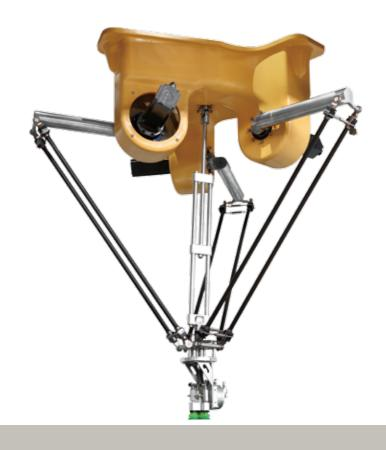
手上的吸盘每次吸取4盒放入纸箱,每箱放3层。装满一箱后,输箱输送带快速的将满箱输出,同时将空箱输送到并联机器人抓放的位置,完成循环的抓放。在效率上,每台装箱机产量稳定达成客户所期望的120盒/分钟,不仅减轻员工工作强度,还大大提升了装箱效率。目前,该项目已投产运行一年,设备状况良好,完全满足客户生产需求!
